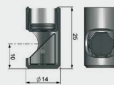
TM-RAM-CS Right angle mirror
